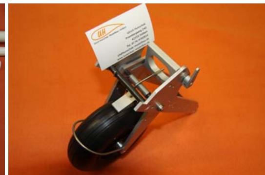
Fema Einziehfahrwerk (1:2,5) incl. Rad, Bremse und Bügel.
