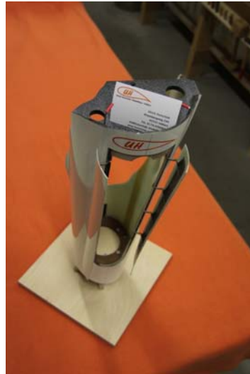
Klapptriebwerksausschnitt incl. Klappen, Klappenmechanik und Unterrahmen. Wir bieten auch die Montage des Klapptriebwerkes an! Preis auf Anfrage!
