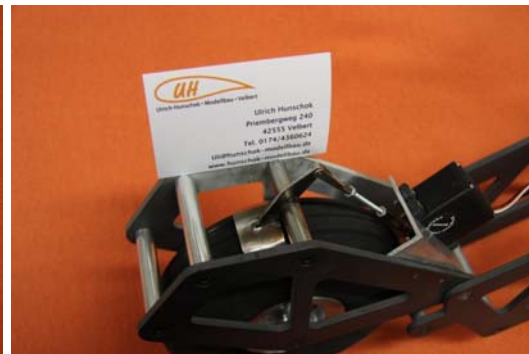
Stargedämpftes Fahrwerk (1:2,5) incl. Rad und Bremse. Preis: 185,00 €
